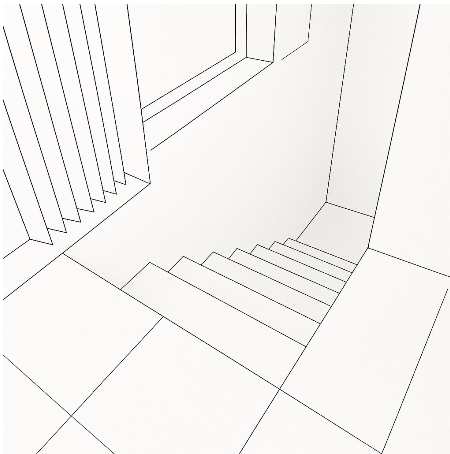
Figur 10 Vinkeltrappe set oppefra uden værn ved nedgang og uden håndliste.
