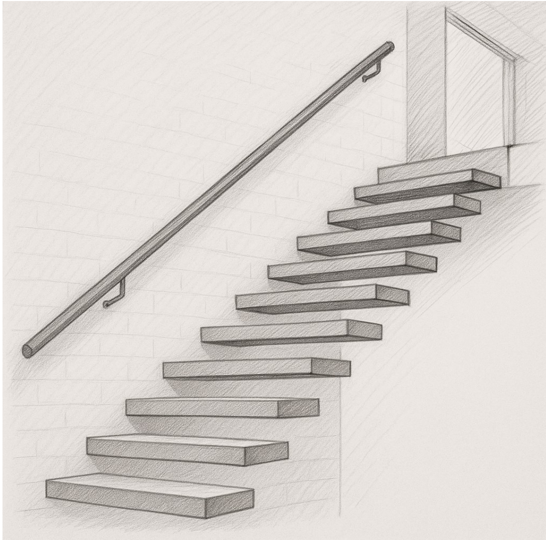
Figur 7 Skitse af en trappe med "svævende" trin og en håndliste på den væg, hvor trinnene er fæstnet. Der er åbent ud til den modsatte side af trappetrinnene (dvs. intet værn/vange på hele den ene side i trappens fulde længde).
