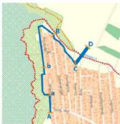
Figur 2-1 Placering og tracé for det planlagte kystbeskyttelsesanlæg. Fjorddiget, der ligger til grund for Natura 2000-vurderingen, udgøres af abrakning AB. Spærningen af etableres som fast spuns. Natura 2000-området er vist ved omrøring (Forsikringskassen 2014).
